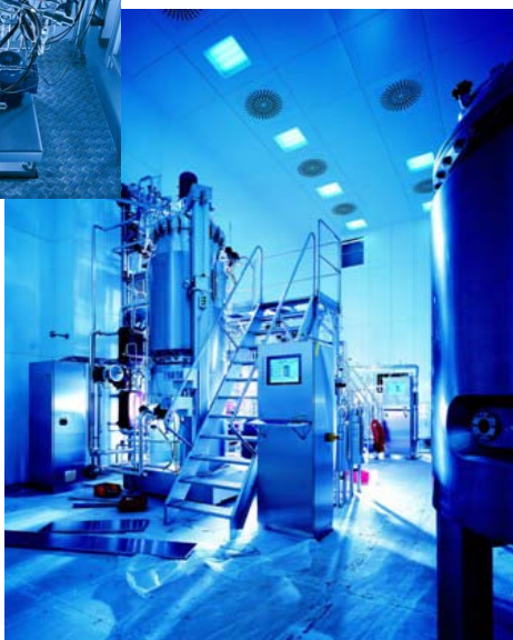
Производственный ферментер, V=150 л
