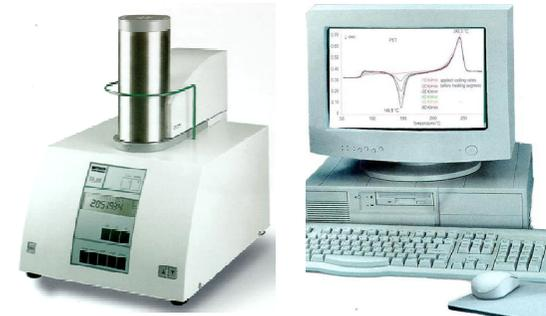
Прибор для комплексного термического анализа STA 449 Jupiter (NETZSCH, Германия)
