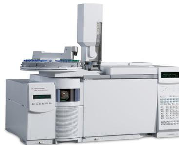
Хромато-масс спектрометр Agilent 5975 Inert (США)
